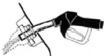
5. Po ukončení zbrojení zavěste pistoli zpět do stojanu a vizuálně zkontrolujte klidový stav zařízení.
