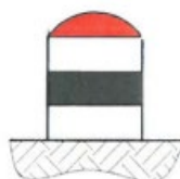
Obr. 1 návěstidlo k upozornění na hranici izolovaného úseku
