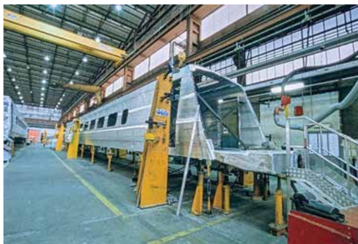
Vzácný pohled na hrubou stavbu čelního vozu jednotky Pendolino ve výrobním závodě v italském Saviglianu v roce 2002.
